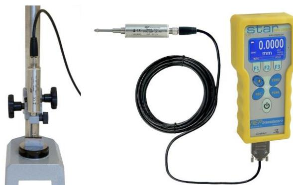
(1) **Star** riconosce automaticamente un massimo di 7 trasduttori collegati alternativamente, **Auto Configurandosi** con i parametri dedicati (Unità di Misura, Filtro, Risoluzione).
