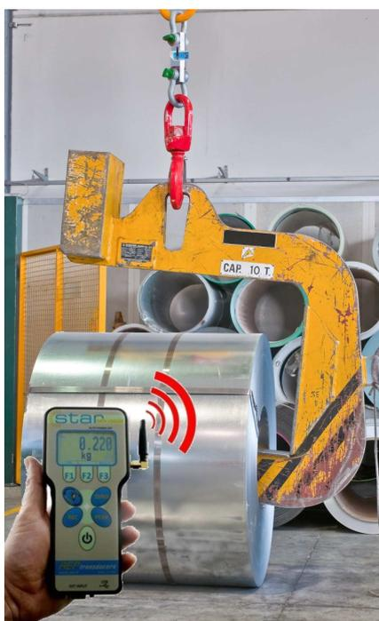
Il dinamometro è composto da una cella di carico realizzata interamente in acciaio inox tipo GR5, T20 o D200 abbinata ad un trasmettitore **WIMOD** alimentato da una batteria interna ricaricabile che garantisce un'elevata autonomia di circa 1000 ore senza la necessità di ricaricarla.
