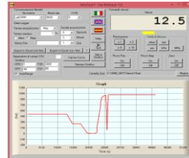
**Quick Analyzer Light:** Software professionale che si interfaccia direttamente al DTR2, supporta l'operatore nelle diverse funzioni di test, analisi, monitoraggio nel tempo, archiviazione dati, gestione diretta del **DATA LOGGER**, trasferimento delle misure su Microsoft Excel.
