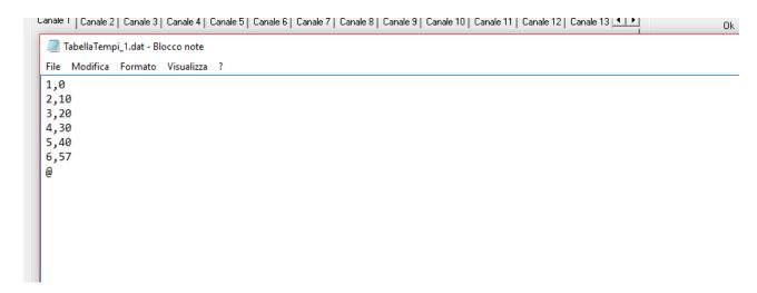
Il file è un normale file di testo. Ogni riga rappresenta un punto di acquisizione. Il primo campo è numero del punto sequenziale, il secondo è il tempo espresso in secondi. Il carattere terminatore del file è : @.
