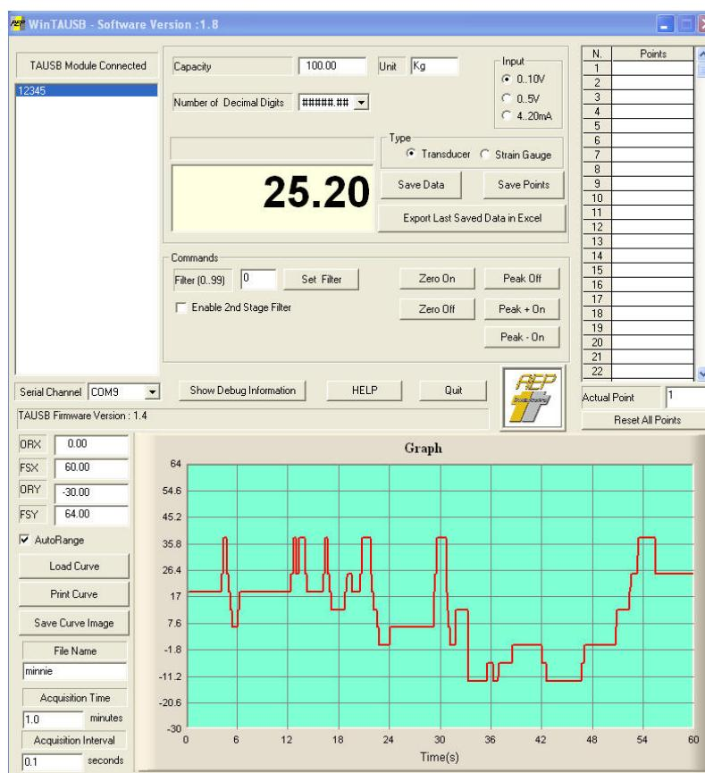
E' stata sviluppata una versione speciale dello strumento TAUSB (denominata TA-USB/S) particolarmente dedicata alla misura dei  $\mu\epsilon$  nel campo della estensimetria.
